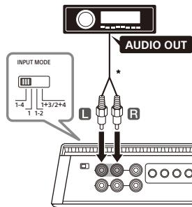
\* Utilice un adaptador de cable de altavoz a RCA (no suministrado) para una conexión de entrada de nivel alto.
