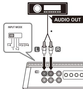
\* Gebruik een luidsprekerkabel-naar-RCA-adapter (niet bijgeleverd) die geschikt is voor een hoogniveau-invoeraansluiting.
