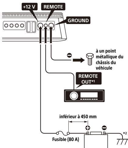
\*1 Si vous disposez de l'autoradio d'origine ou d'un autre autoradio dépourvu de sortie de commande à distance pour l'amplificateur, raccordez la borne d'entrée de commande à distance (REMOTE) à l'alimentation ACC. Avec un raccordement des entrées haut niveau, l'amplificateur peut également être activé sans qu'un raccordement REMOTE soit nécessaire. Néanmoins, cette fonction n'est pas garantie pour tous les autoradios.
