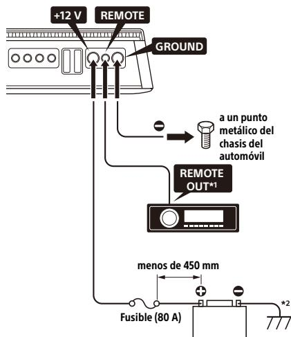
\*1 Si tiene el original de fábrica o alguna otra unidad de audio del automóvil sin una salida remota para el amplificador, conecte el terminal de entrada remota (REMOTE) a la fuente de alimentación ACC. En la conexión de entrada de alto nivel, el amplificador también puede activarse sin necesidad de conexión REMOTE. Sin embargo, esta función no está garantizada en todas las unidades de audio de vehículos.
