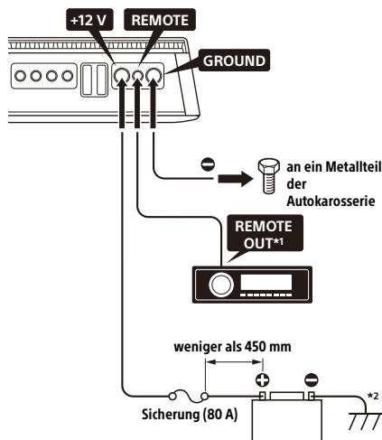
\*1 Bei der werkseitigen oder einer anderen Autoanlage ohne Fernbedienungsausgang für den Verstärker verbinden Sie den Fernbedienungseingang (REMOTE) mit der Stromversorgung für Zubehörgeräte. Bei einer Hochpegel-Eingangsverbindung kann der Verstärker auch ohne REMOTE-Verbindung aktiviert werden. Es kann jedoch nicht garantiert werden, dass diese Funktion bei allen Autoanlagen zur Verfügung steht.
