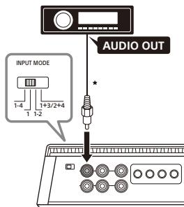
\* Gebruik een luidsprekerkabel-naar-RCA-adapter (niet bijgeleverd) die geschikt is voor een hoogniveau-invoeraansluiting.
