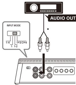
\* Använd en högtalarkabel-till-RCA-adapter (medföljer ej) för anslutning med hög inmatningsnivå.
