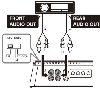
\* Gebruik een luidsprekerkabel-naar-RCA-adapter (niet bijgeleverd) die geschikt is voor een hoogniveau-invoeraansluiting.
