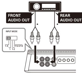
\* Utilice un adaptador de cable de altavoz a RCA (no suministrado) para una conexión de entrada de nivel alto.
