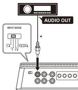
\* Utilice un adaptador de cable de altavoz a RCA (no suministrado) para una conexión de entrada de nivel alto.
