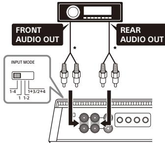
\* Använd en högtalarkabel-till-RCA-adapter (medföljer ej) för anslutning med hög inmatningsnivå.
