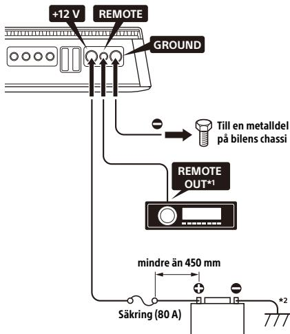
\*1 Anslut uttaget för fjärringång (REMOTE) till ACC-strömförskjoningens när du använder originalstereo eller annan bilstereo utan fjärrutgång för förstärkaren. Förstärkaren kan också aktiveras utan att REMOTE-anslutning krävs vid anslutning för hög inmatningsnivå. Denna funktion garanteras inte fungera med alla bilsterreoer.
