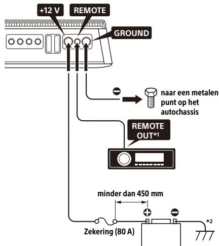
\*1 Als u een originele fabrieksautoradio of een ander type zonder afstandsbedieningsuitgang voor de versterker hebt, verbindt u de afstandsbedieningsuitgang (REMOTE) met de ACC-voeding. Bij een hoogniveau-invoeraansluiting kan de versterker ook zonder REMOTE-verbinding geactiveerd worden. Wij kunnen echter niet garanderen dat deze functie werkt bij alle autoradio's.
